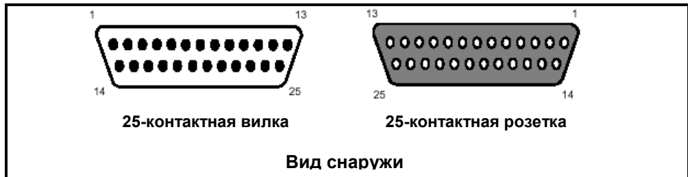
Рис. 8- 11. Стандартная нумерация контактов разъемов типа D.
